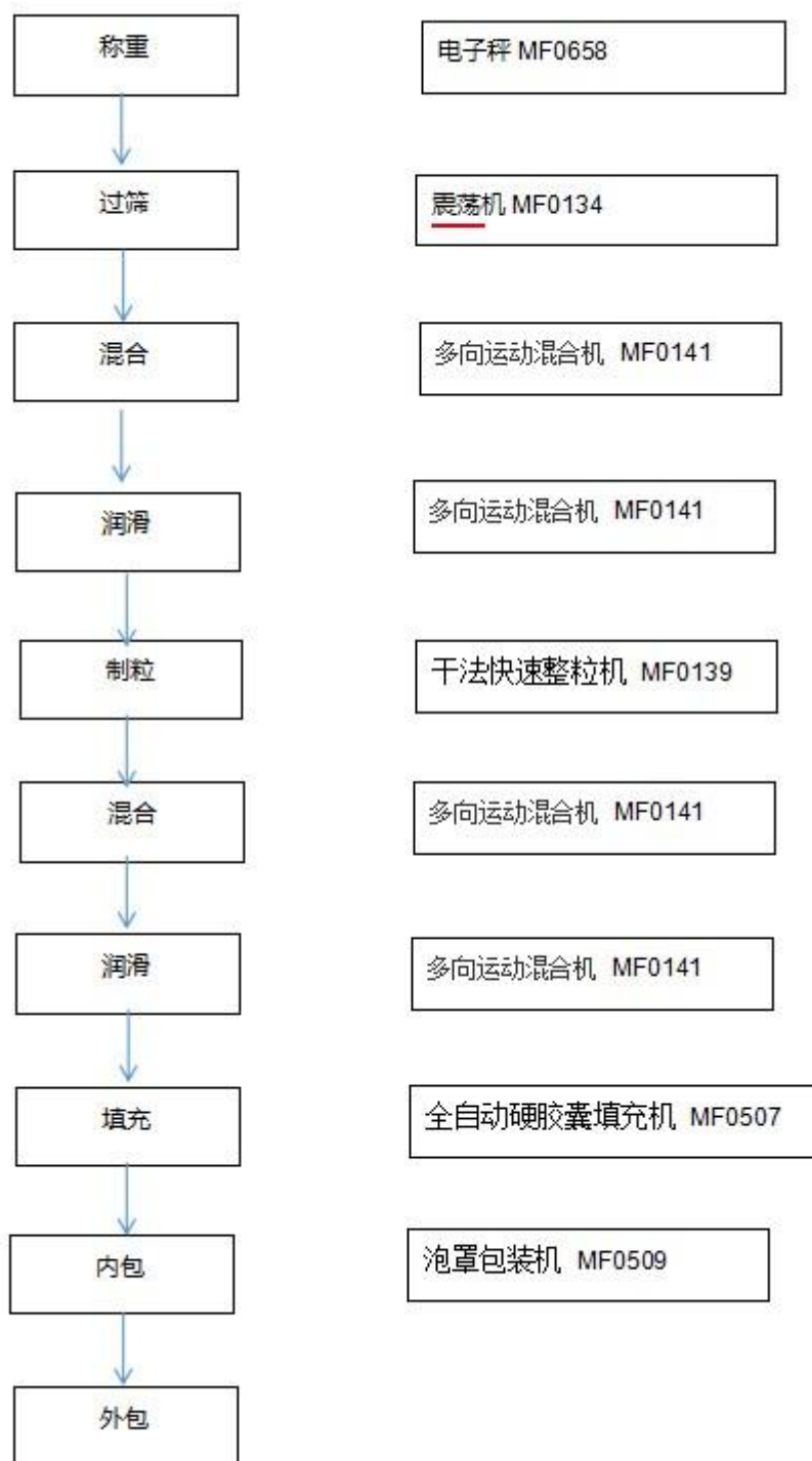
图 2 胶囊剂生产工艺流程及排污节点图
